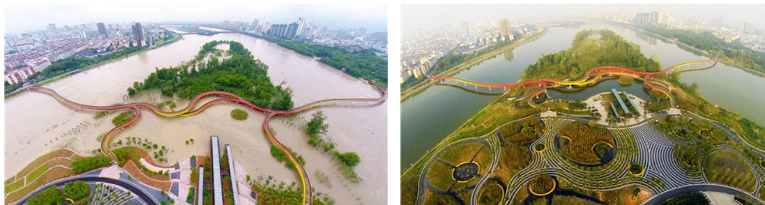
图 4-5-1 洲滩湿地公园洪水位（左）与常水位、低水位比较图（右）
